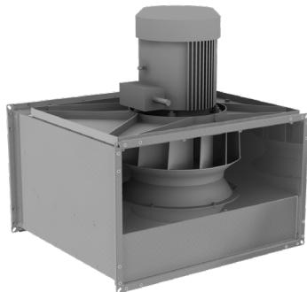
Вентиляторы канальные серий ВРК-Н / ВРК-НК производства компании ИНЕСИС предназначены для применения в системах общеобменной и приточной противодымной вентиляции для перемещения воздуха температурой до 80 °C (серия Н) и до 200 °C (для серии НК).
